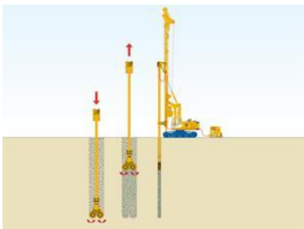
Figura 7: Tecnologia CSM - fasi di esecuzione.
